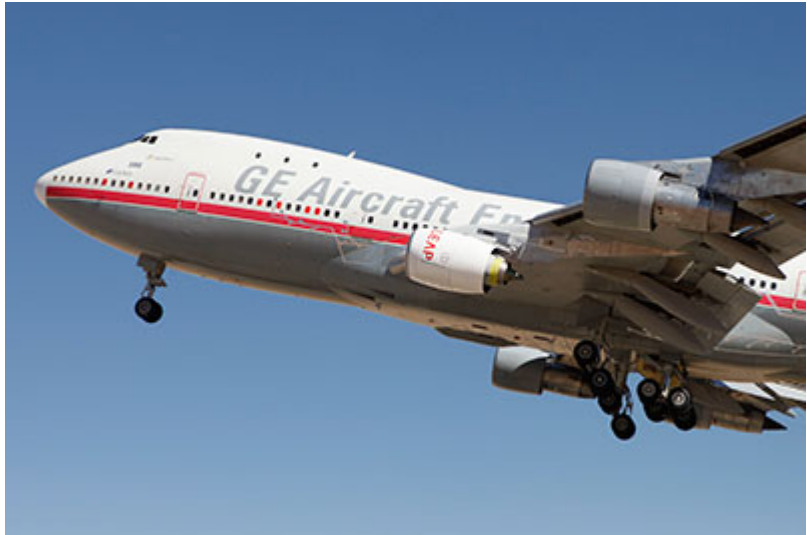
奈赛为 CFM 国际公司 LEAP 1-C 发动机开发的集成推进系统短舱，于 10 月 6 日在 GE 航空 747 测试平台上实现首次机载飞行测试。
